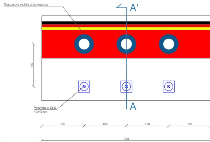
Pianta tipo per varco a tre dissuasori scala 1:50
