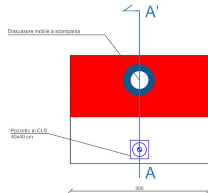
Pianta tipo per varco a un dissuasore scala 1:50
