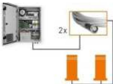
I quadri di comando andranno posizionati nei plessi precedentemente indicati e, ove possibile, all'interno di locali tecnici e alimentati da un punto di potenza f.m. precedentemente individuato. L'alimentazione dei quadri avverrà tramite tre (3) cavi a doppio isolamento di sezione 1.5 mm<sup>2</sup> (fase, neutro e giallo-verde) e ognuno andrà protetto da interruttore magnetotermico bipolare da 6A posizionato in quadro elettrico esistente o in centralino da 8 moduli DIN.
