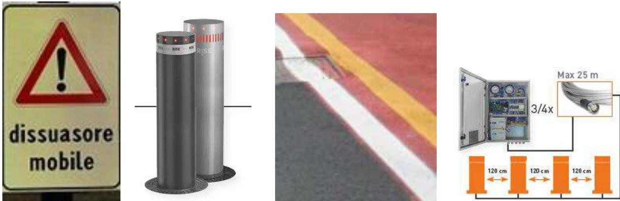
L'alimentazione a 220V dei dissuasori elettrici verrà realizzata con linee elettriche autonome per la necessità di alimentarli sotto UPS e gruppo elettrogeno. I quadri di alimentazione e comando saranno posizionati nei locali tecnici dei più vicini plessi e collegati poi tra loro attraverso la rete LAN del Centro.
