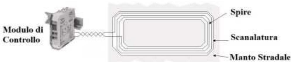
Per il posizionamento dei cavidotti si dovranno rispettare le profondità previste dalla DL e/o dal produttore del sistema.
