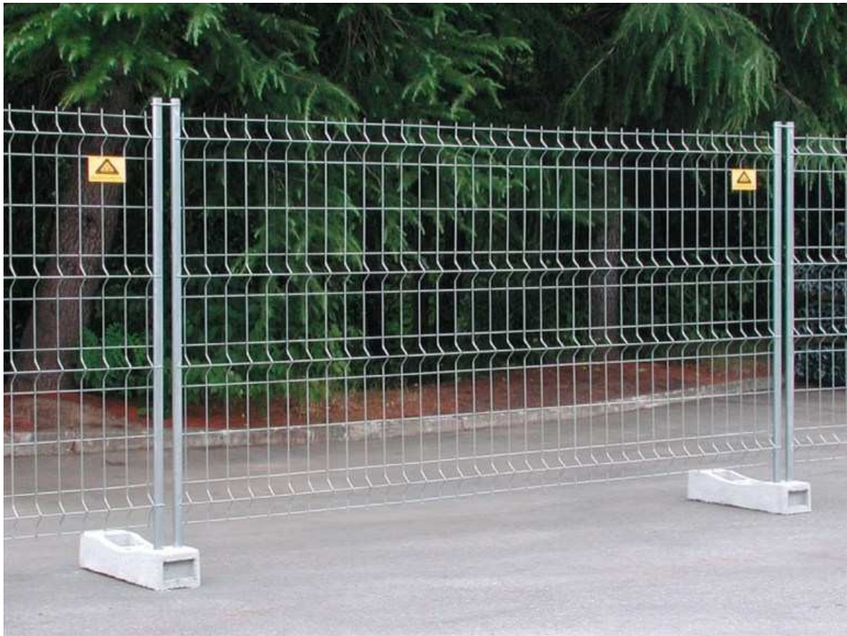
Figura 2: Modulo Recinzione Temporanea dotata di CERTIFICAZIONE STATICA (dim 3,00*2,00) - Fili orizzontali e verticali: 3,2mm - Maglia 100*300mm - Tubo orizzontale: diametro 30mm - Tubo verticale: diametro 40mm - completo di elementi di zavorra in cls - vibrato di adeguato peso.
